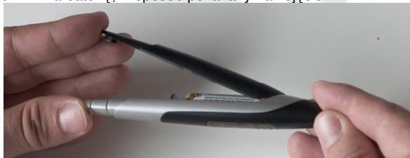
4. Wyjmij starą baterię i włóż na jej miejsce nową, zwracając uwagę na poprawne położenie biegunów
