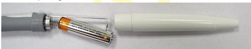
3. Vergewissern Sie sich, dass die Lage der Batteriepole der folgenden Abbildung entspricht.
