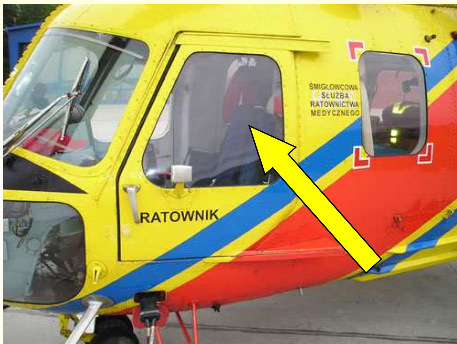
Drzwi przednie lewe. Możliwe otwarcie awaryjne po wybiciu szyby.
