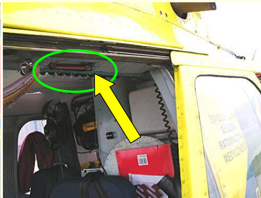
Uchwyt do awaryjnego otwarcia lewych przednich drzwi - czerwona rączka nad drzwiami.
