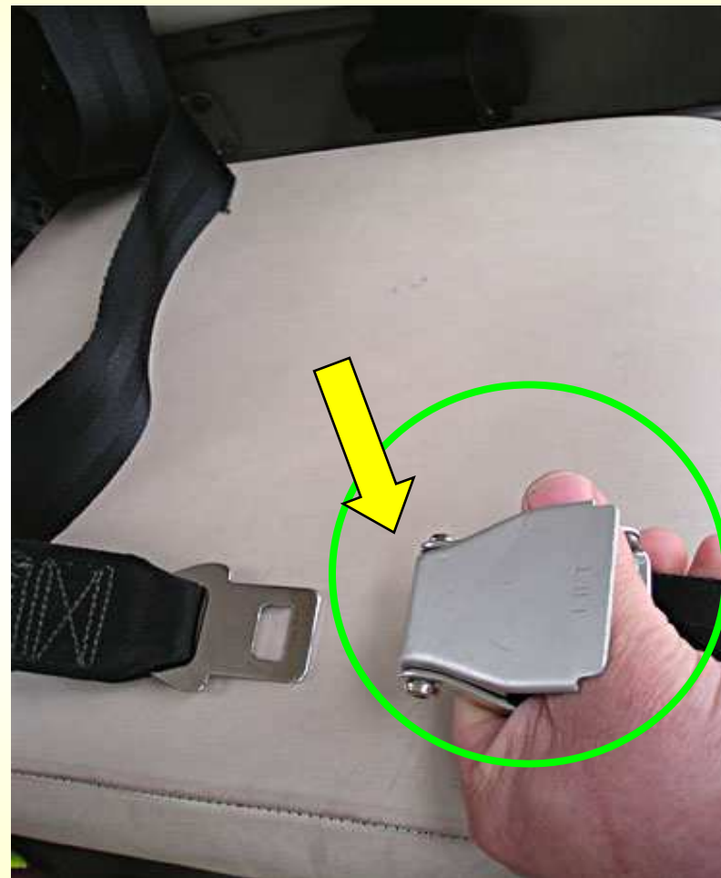
Pasy na fotelu Lekarza i Ratownika w kabinie medycznej - rozpięte poprzez uniesienie widocznego elementu zapięcia.
